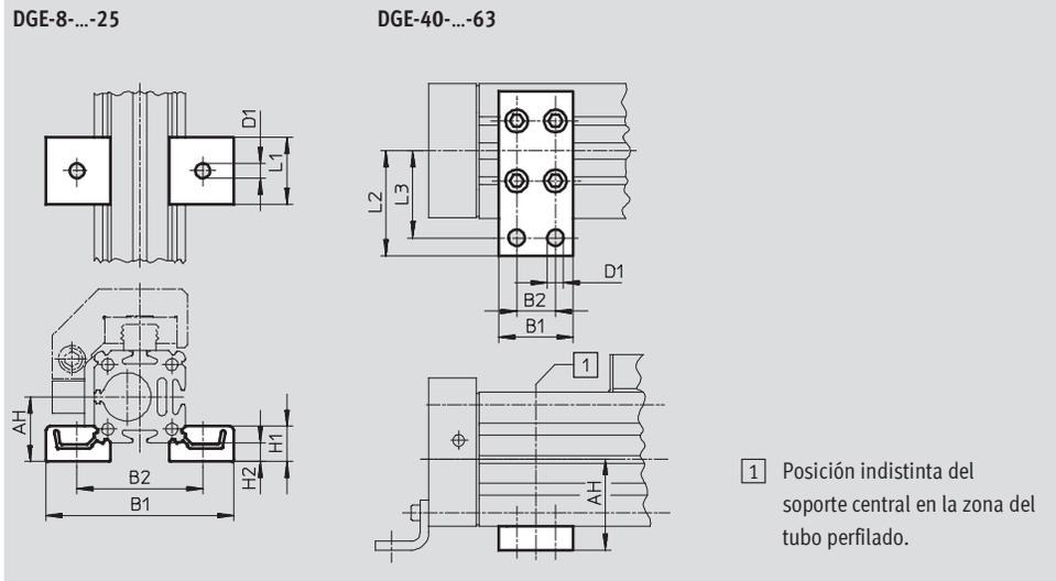
1 Posición indistinta del soporte central en la zona del tubo perfilado.
