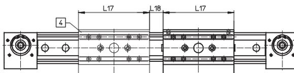
Combinando un eje con correa dentada con un carro adicional, se reduce la carrera útil en función de la longitud del carro adicional y de la distancia entre los dos carros.
