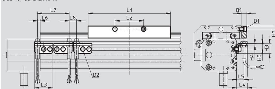
1 Prever espacio suficiente para el cable del detector
