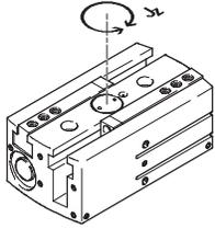
Momento de inercia de la masa de la pinza paralela, tomando como referencia el eje central. Sin dedos externos, sin carga.
