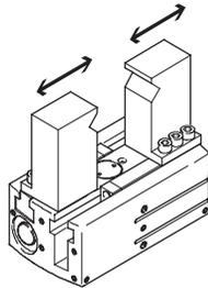
Los tiempos de apertura y de cierre [ms] aquí indicados fueron medidos a temperatura ambiente, con una presión de funcionamiento de 6 bar y con la pinza sin dedos adicionales y montada en posición horizontal. Al aplicar
