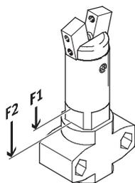
Fuerza teórica de accionamiento del compensador de carrera en la variante con compensación de carrera.
