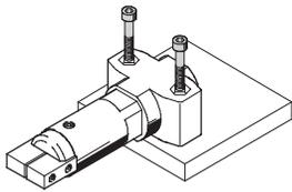
Mediante taladros, tornillos y tuercas de fijación
