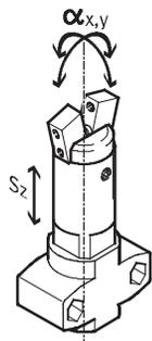
Las pinzas angulares tienen una holgura entre los dedos y el elemento de guía debido al sistema de guía de deslizamiento. Los valores que constan en la tabla siguiente fueron calcula-
