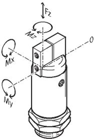
Las fuerzas y momentos admisibles se refieren a un dedo. Los datos en condiciones estáticas se refieren a la carga adicional ocasionada por las
