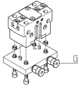
1 Conexiones para el aire comprimido
