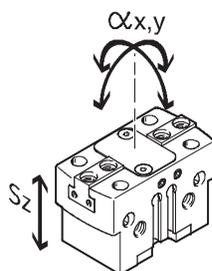
Las pinzas tienen una holgura entre los dedos y el cuerpo debido al sistema de guía de deslizamiento. Los valores correspondientes a la holgura que constan en la tabla fueron calculados aplicando el método convencional de adición de tolerancias.
