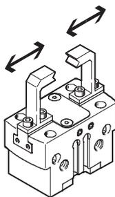
Los tiempos de apertura y de cierre [ms] aquí indicados fueron medidos a temperatura ambiente, con una presión de funcionamiento de 6 bar y con la pinza sin dedos adicionales y montada en posición horizontal. Al aplicar
