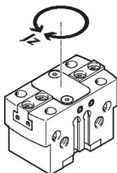
Momento de inercia de la masa de la pinza paralela, tomando como referencia el eje central. Sin dedos externos, sin carga.
