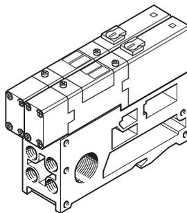
En el caso de las válvulas MAXI, las zonas de presión diferentes se consiguen intercalando una placa ciega. En ese caso, la alimentación se realiza a través de la placa de adaptación.
