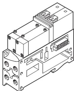
En el caso de las válvulas MIDI, la creación de zonas de presiones diferentes (incluyendo también vacío) se obtiene mediante un bloque de alimentación de zonas de presión. Es recomendable que las presiones más bajas sean alimentadas cerca del nodo.
