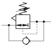
Para controlar la fuerza de los cilindros es posible montar un regulador entre la placa base y la válvula correspondiente.
